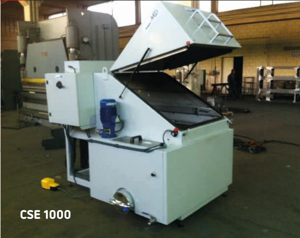
Cabina a lancia per lavaggio manuale ad alta pressione.
