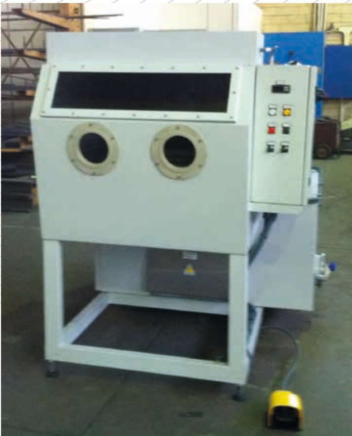
Cabina a lancia per lavaggio manuale ad alta pressione.
